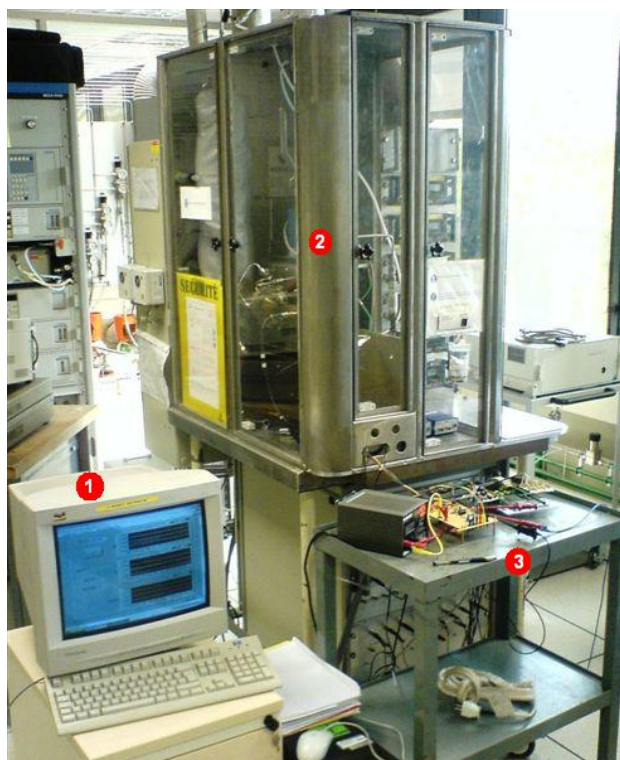
Figure H.1: Vue générale du dispositif expérimental (1: enregistrement des résultats par NI LabVIEW; 2: Banc gaz pour sondes proportionnelles; 3: microcontrôleur et interface électronique.
